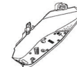
แผ่นรองพักเท้าข้างซ้าย BOARD, FOOTREST BBR-F7481-01
