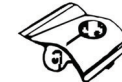
ฝาครอบไฟท้ายด้านบน COVER, TAIL 1 BBR-F471K-00-P0
