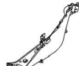
แผ่นรองพักเท้าข้างขวา BOARD, FOOTREST 2 BBR-F7488-01
